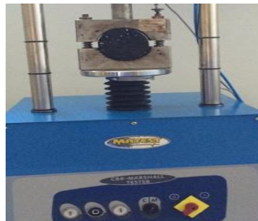
(d) Stability and flow tests
