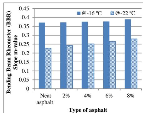
**Fig. 14. Effects of NS ratios on BBR values for PAV binder.**
