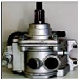
Fig. 9. ATV-Buggy reverse gearbox, model ATV 009-Sophie.
