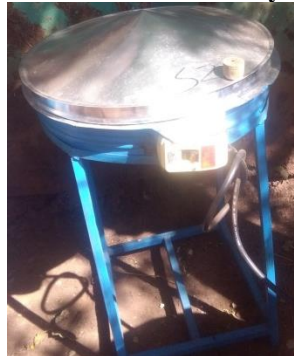
(d) Final assembly electric Injera baking mitad.
