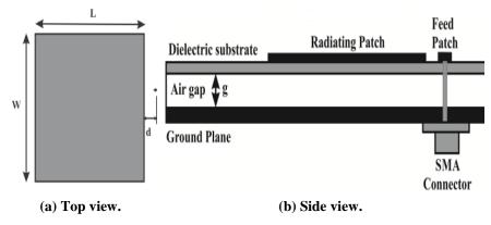
Fig. 1. Reference antenna.
