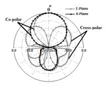
(d) E-plane and H-plane radiation pattern at 2.89 GHz.
