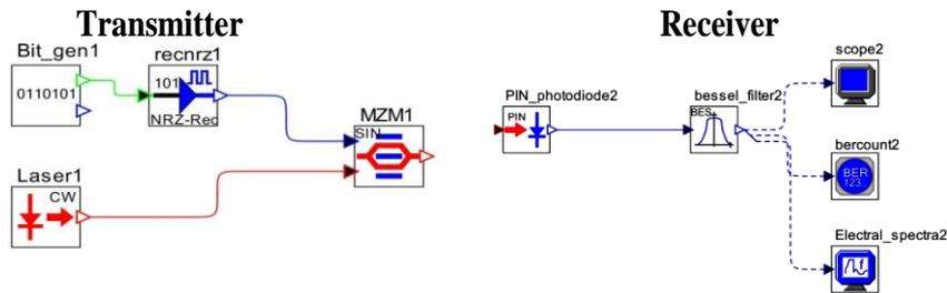
Fig. 6. NRZ Modulation format.
