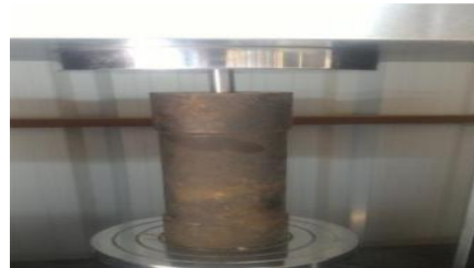
(d) The sample milled for compression test
