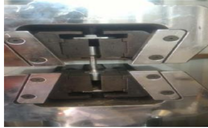
(d) The sample milled for tensile test
