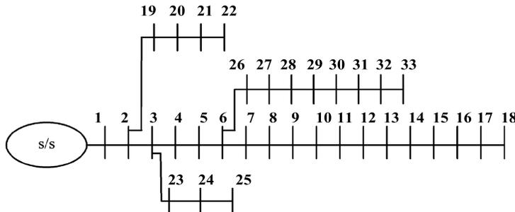
Fig. 5. IEEE 33-Bus Test System.
