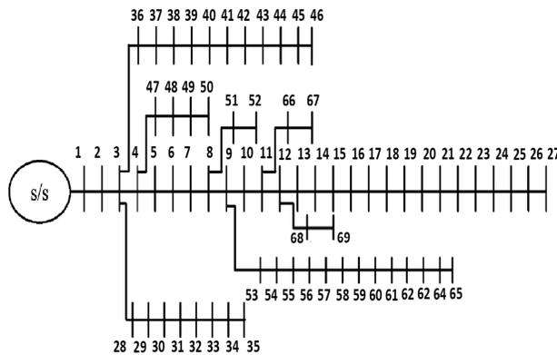
Fig. 6. IEEE 69-Bus Test System.
