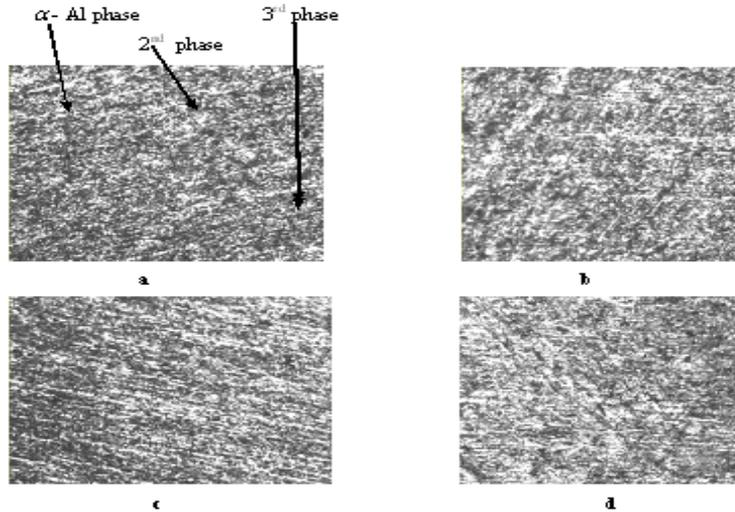
**Fig. 4. Microstructures of Cast Samples (a) CO<sub>2</sub>, (b) Cement, (c) Metal and (d) Sand Moulds.**
