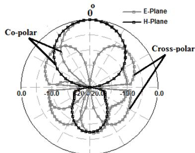
(d) E-plane and H-plane radiation pattern at 2.89 GHz.
