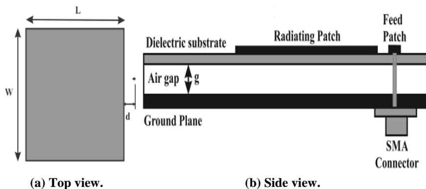
Fig. 1. Reference antenna.
