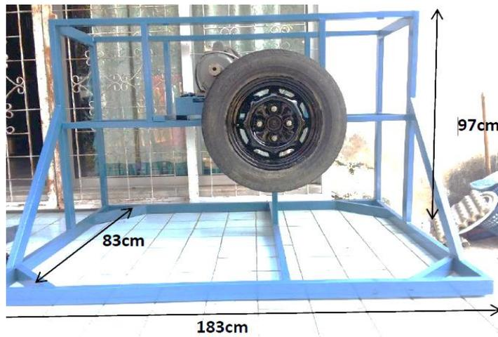
Fig. 4. Fabricated test-rig.
