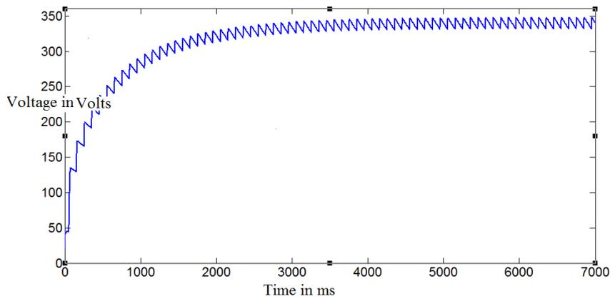
Fig. 20. DC link voltage.
