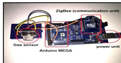
**Fig. A-5. Gas end device.**
